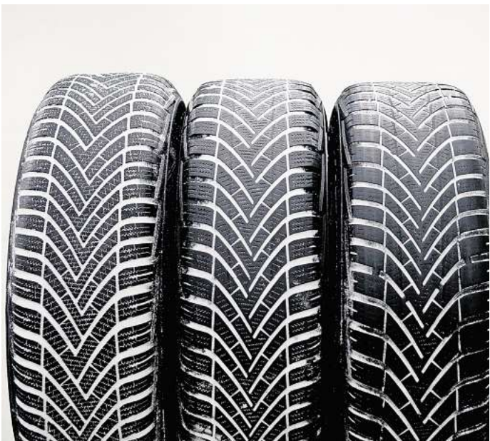
SICHERHEITSRISIKO: Der gleiche Reifen mit drei verschiedenen Profiltiefen (links neu, Mitte 4 mm, rechts 2 mm).
