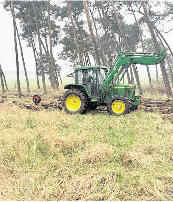
„Waldmeisterpflug“ am Traktor: Das Anbaugerät zieht Pflugreihen, in die später junge Bäume gesetzt werden – der Boden wird freigelegt und Gras als Begleitvegetation aufgerissen, damit die Pflanzen im Mineralboden anwurzeln können. Fotos: Forstbezirk Taura
