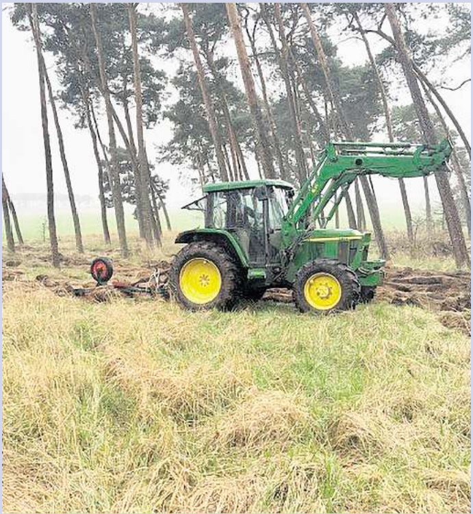
„Waldmeisterpflug“ am Traktor: Das Anbaugerät zieht Pflugrei- hen, in die später junge Bäume gesetzt werden – der Boden wird freigelegt und Gras als Begleitvegetation aufgerissen, damit die Pflanzen im Mineralboden anwurzeln können. Fotos: Forstbezirk Taura
