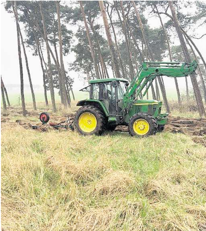
„Waldmeisterpflug“ am Traktor: Das Anbaugerät zieht Pflureihen, in die später junge Bäume gesetzt werden – der Boden wird freigelegt und Gras als Begleitvegetation aufgerissen, damit die Pflanzen im Mineralboden anwurzeln können. Fotos: Forstbezirk Taura
