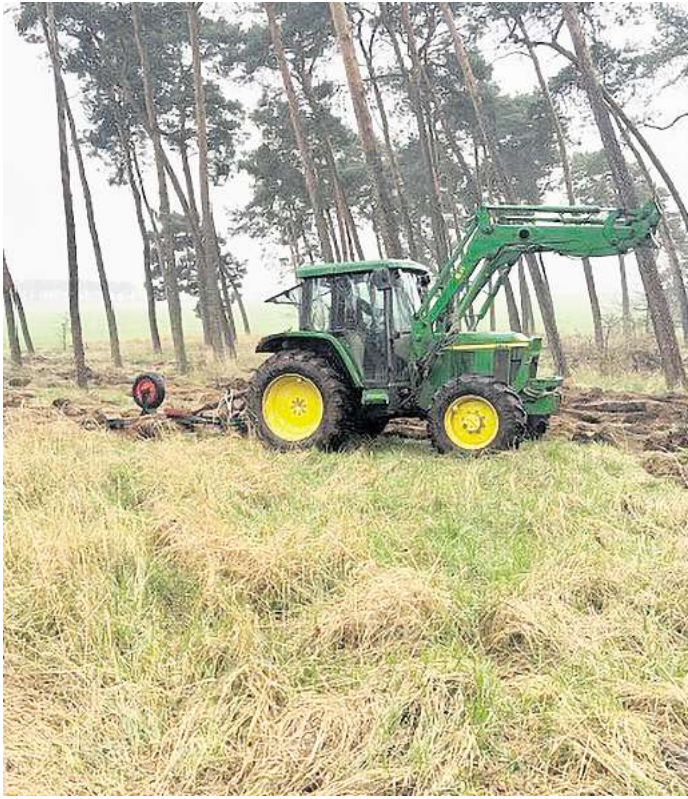
„Waldmeisterpflug“ am Traktor: Das Anbaugerät zieht Pflureihen, in die später junge Bäume gesetzt werden – der Boden wird freigelegt und Gras als Begleitvegetation aufgerissen, damit die Pflanzen im Mineralboden anwurzeln können. Fotos: Forstbezirk Taura
