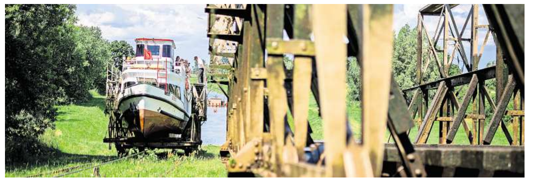
Weiße Flotte auf Schienen: Am Oberlandkanal werden Schiffe in einem Wagen den Hang hinaufgezogen – angetrieben von Wasserkraft. Foto: Zegluga Ostródzko-Elblaska/dpa
